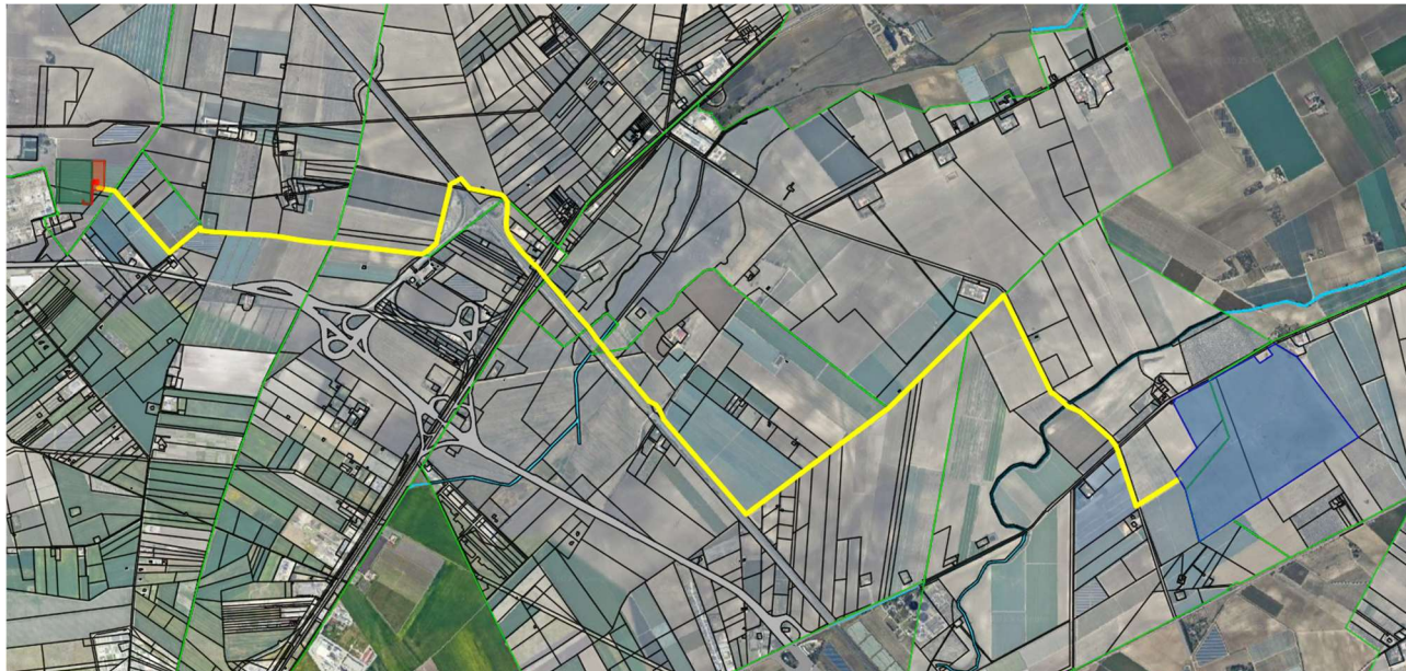
Figura 2-1: Localizzazione complessiva catastale su ortofoto dell'area di intervento, giallo il tracciato della connessione MT, in rosso la connessione AT, in arancio l'area della SSEU e in Verde l'area dell'ampliamento della SE, in azzurro la perimetrazione di progetto.
